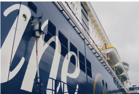
Rahmenbedingungen zu verbessern.“ Bauherr der Landstromanlage, die von der Siemens AG errichtet wird, ist der PORT OF KIEL. Die Investitionssumme beläuft sich auf 1,3 Mio. Euro. Die Anlage hat eine maximale Anschlussleistung von 4,5 Megawatt (MW) bei einer elektrischen Spannung von 10 Kilovolt (KV) und einer Netzfrequenz von 50 Hertz (Hz). Am Norwegenkai sind die Emissionen von Luftschadstoffen und Klimagasen künftig gleich Null.
